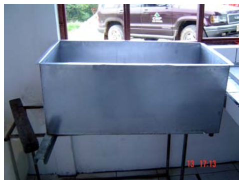
Fotografía N°. 8. Tina doble forro de fabricante artesanal
